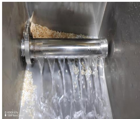
永旺厂一工程洗米水槽反冲水管节水优化改善;每天可节省2到3吨水,年节约费用0.07万元
