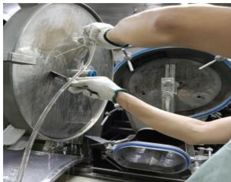
大旺厂蒸练机锅体清机水管改善;年节约费用0.5万元
